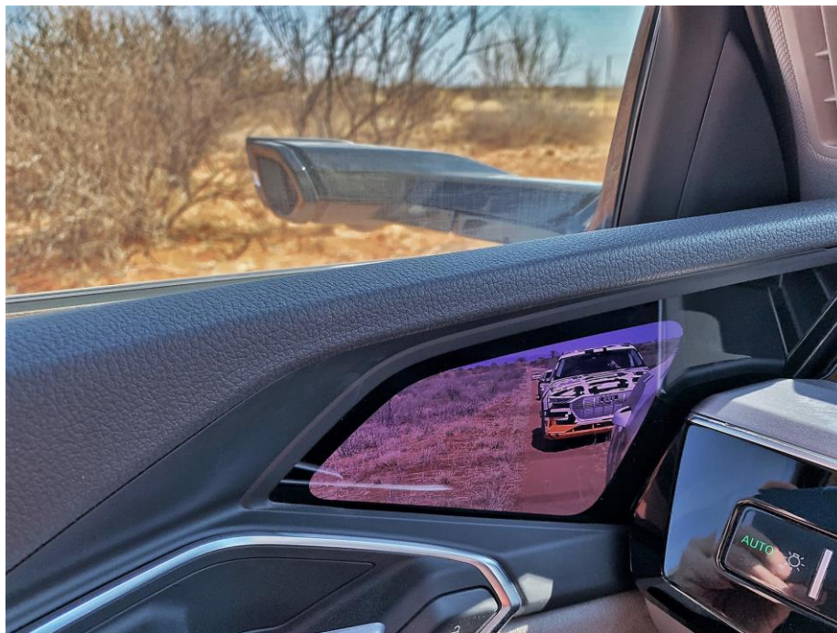
Slika 9. Kamera u funkciji retrovizora u Audi E-tronu
