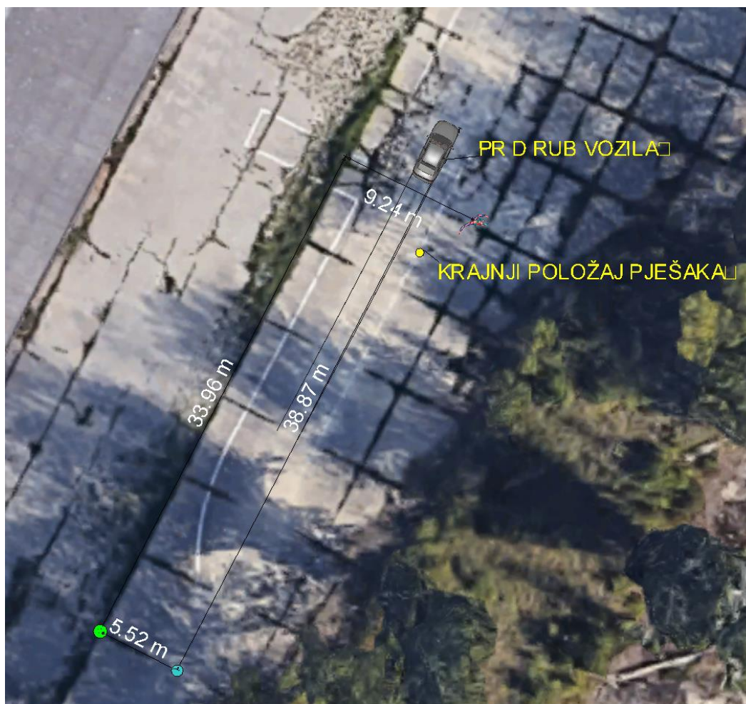
Slika 32. Simulacija naleta osobnog vozila Hyundai Accent na lutku I pri brzini 66,60 km/h
