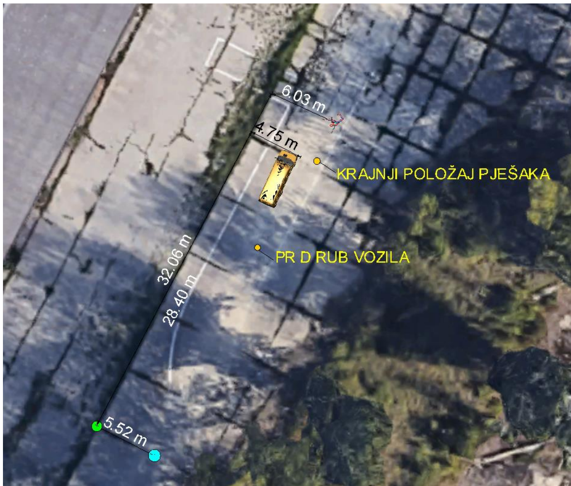
Slika 28. Simulacija naleta dostavnog vozila Renault Trafic na lutku pri brzini 64.84 km/h
