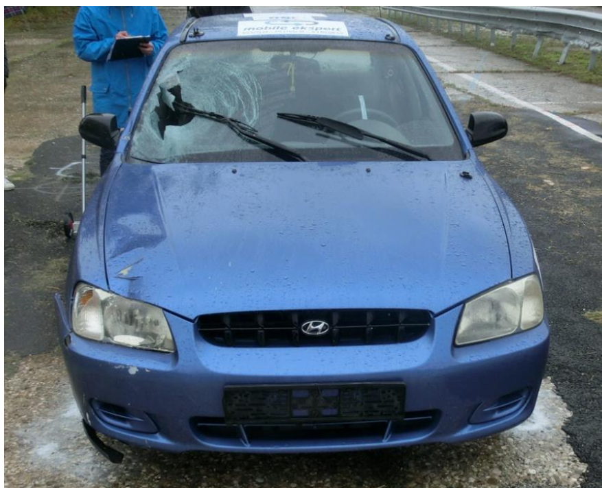
Slika 22. Prikaz oštećenja na vozilu uzrokovanih naletom na lutku
