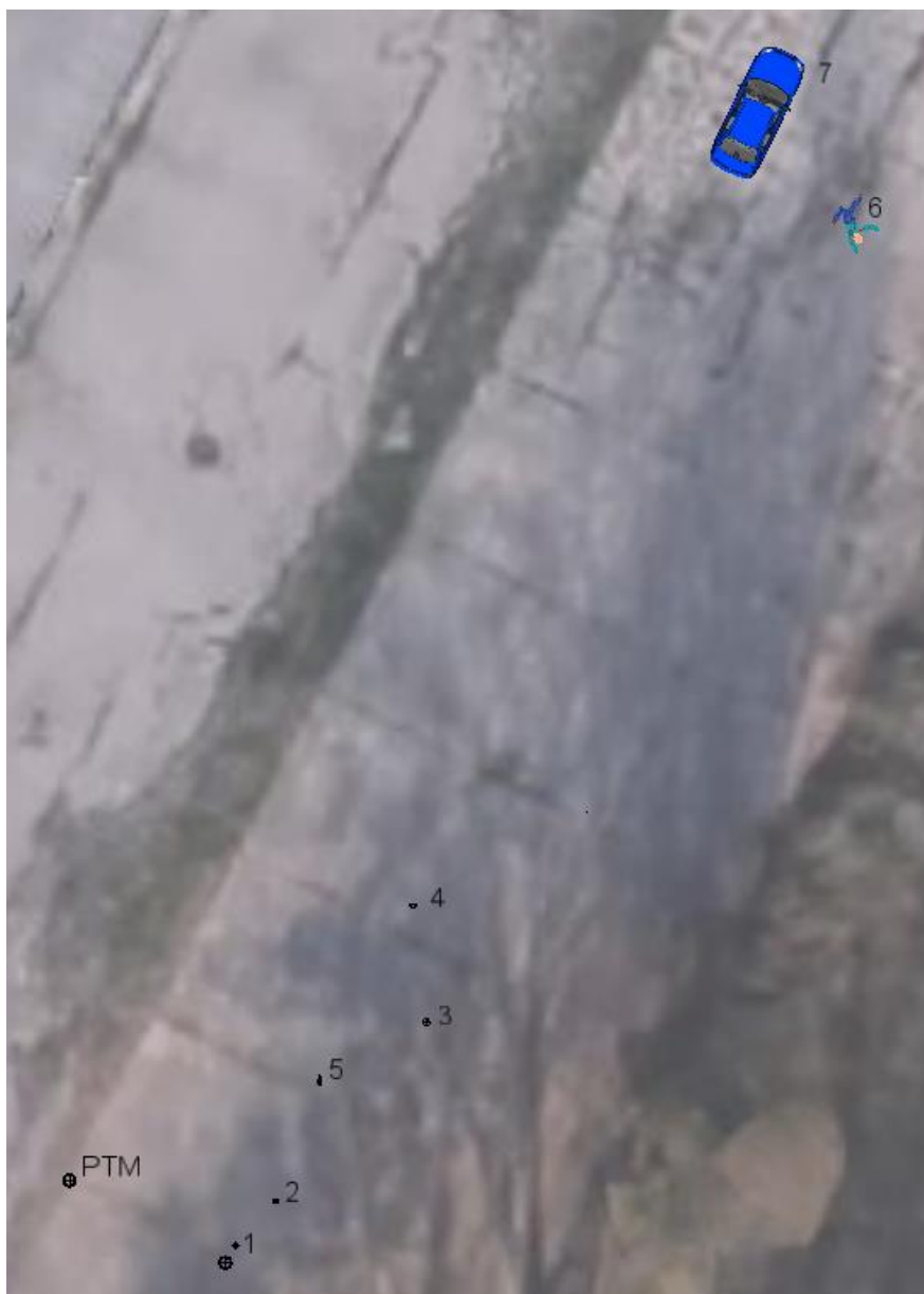
Slika 21. Situacijski plan naleta osobnog vozila Hyundai Accent na odraslu lutku pri brzini 80 km/h
