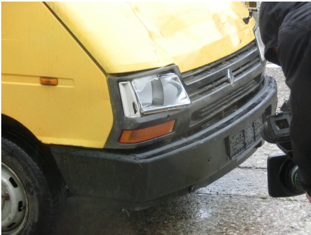
Slika 18. Prikaz oštećenja na vozilu uzrokovanih naletom na lutku II
