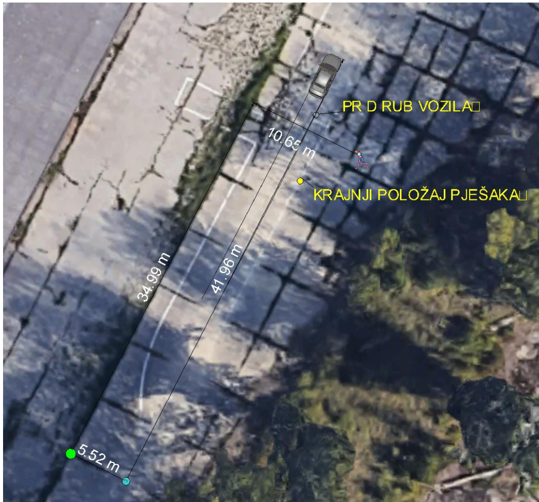
Slika 33. Simulacija naleta osobnog vozila Hyundai Accent na lutku I pri brzini 69,04 km/h
