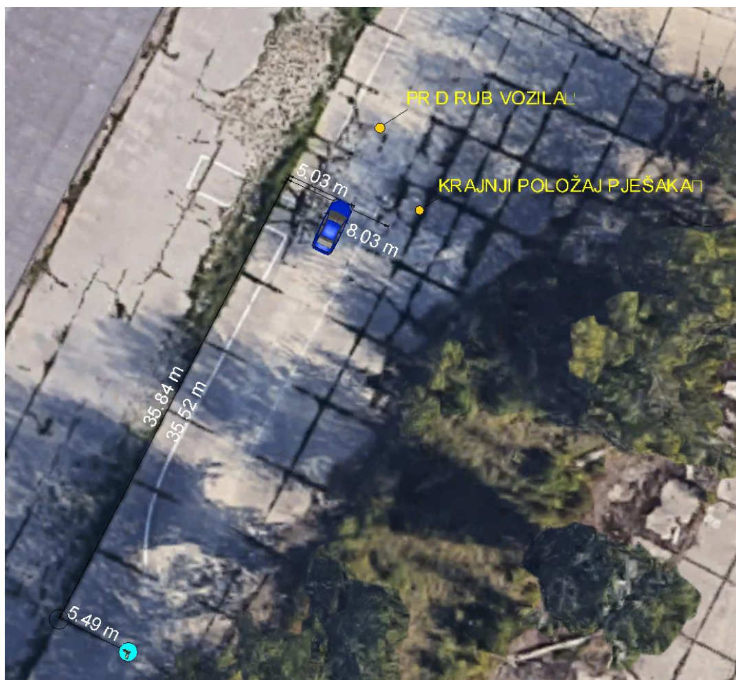
Slika 35. Simulacija naleta osobnog vozila Hyundai Accent na lutku II pri brzini 74,00 km/h
