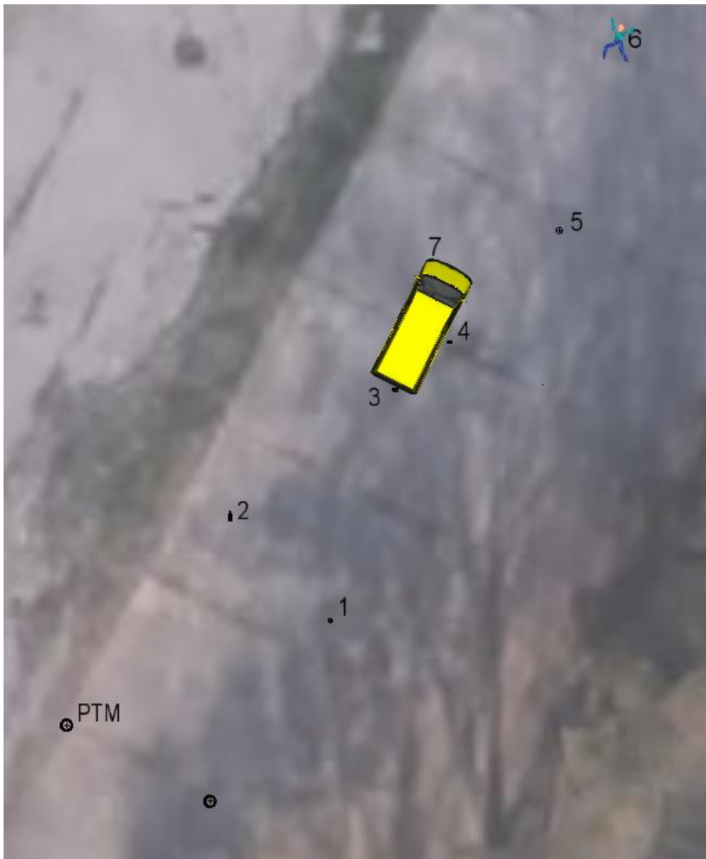
Slika 17. Situacijski plan naleta dostavnog vozila Renault Trafic na lutku (dijete)
