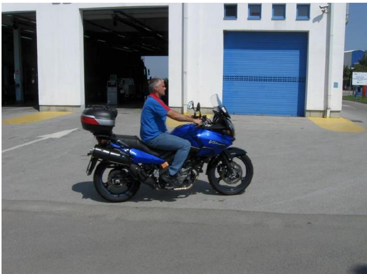
Slika 9. Dinamičko ispitivanje kočnog sustava bez valjaka – stražnja kočnica[8]
