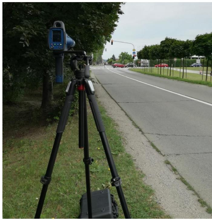
Slika 7.44: Snimanje (mjerjenje) brzine na lokaciji 1
