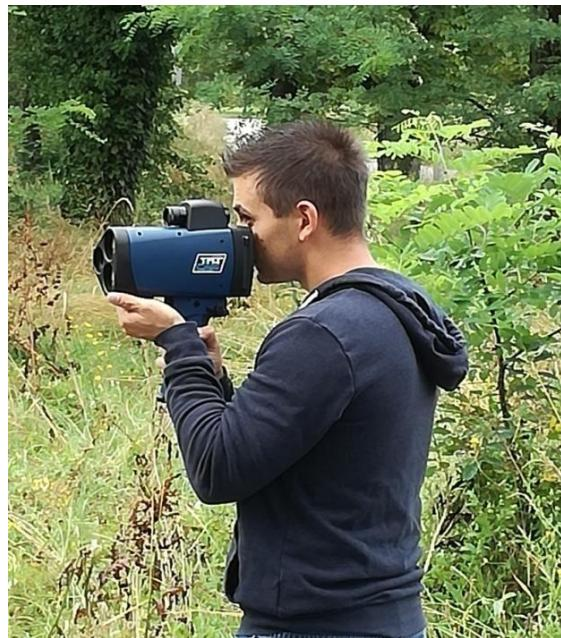
Slika 7.45: Snimanje (mjerjenje) brzine na lokaciji 2
