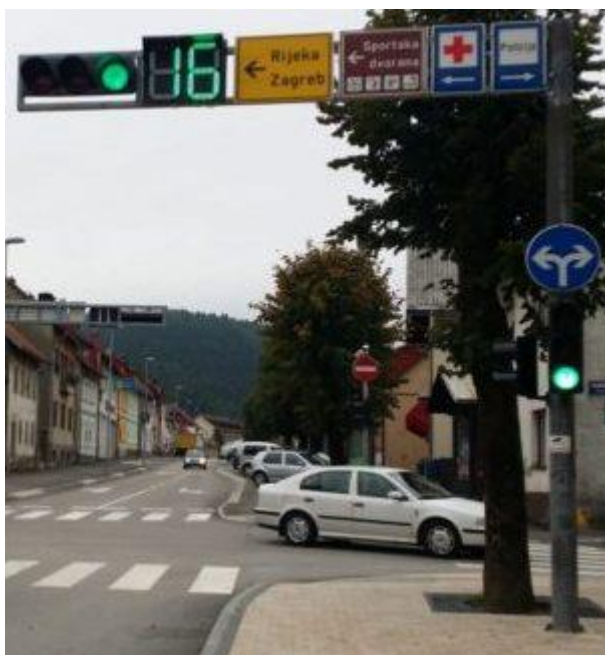
Slika 6.41: Brojač vremena na semaforskom uređaju Izvor: [26]
