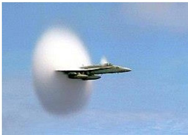
*Slika 21. Probijanje zvučnog zida [15]*
