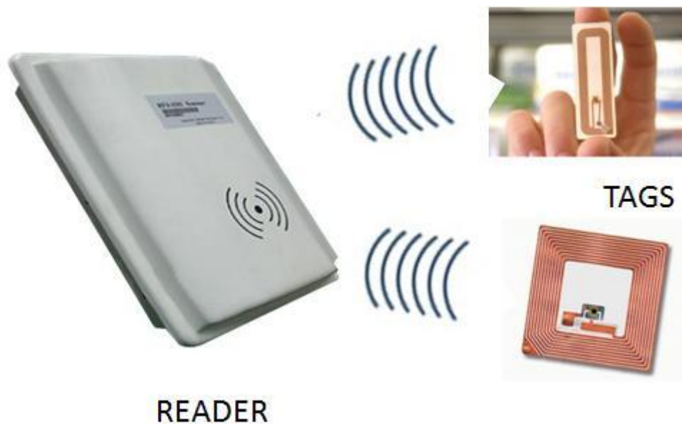
Slika 1. Princip rada RFID tehnologije [22]
