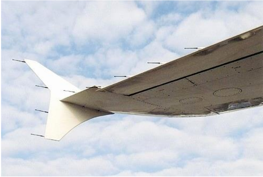
Slika 7. Statičko pražnjenje na primjeru zrakoplova A320, [19]
