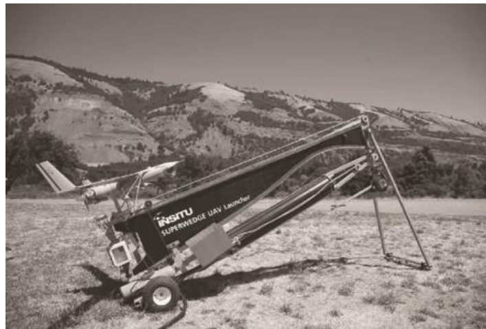
Slika 9. Sustav lansiranja drona putem katapulta
