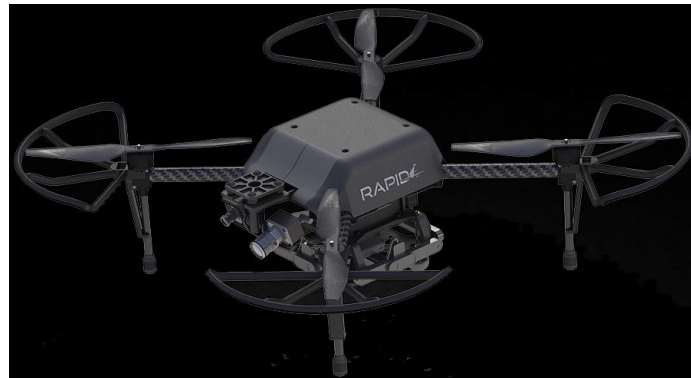
Slika 41. RAPID dron za inspekciju putničkih zrakoplova
