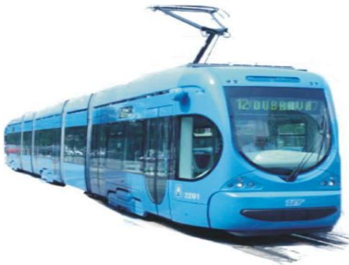
Slika 3. Niskopodni tramvaj [6]
