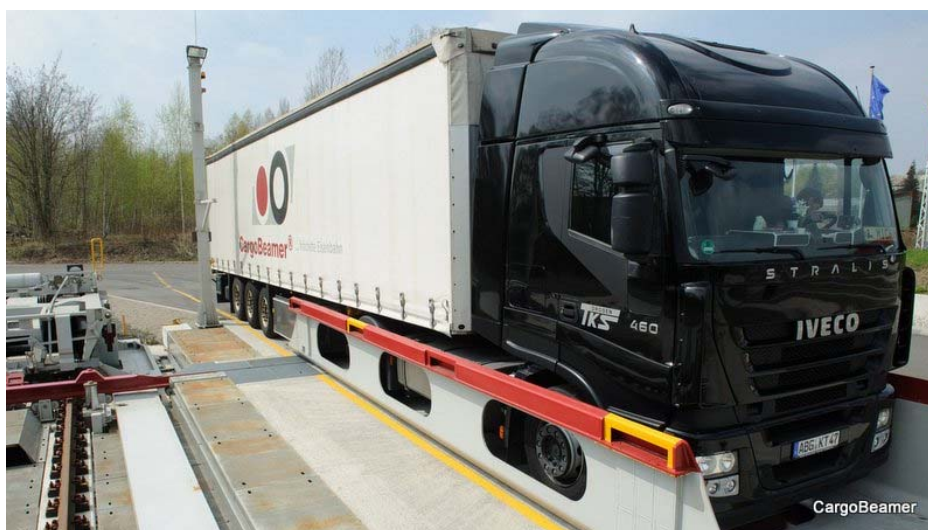
Slika 24. Prikaz CargoBeamer paleta na kojoj se nalazi kamion Izvor: https://www.cargobeamer.eu/The-pallets-850347.html (03. 09. 2019.)
