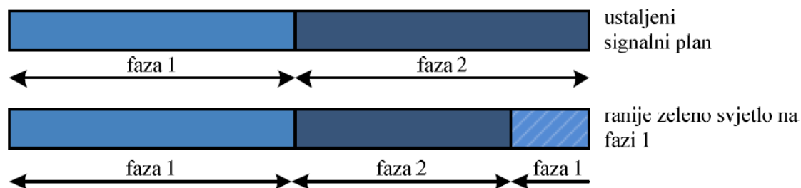
Slika 4: Grafički prikaz tehnike ranijeg početka zelenog svjetla [6]
