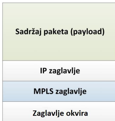
Slika 9. Struktura paketa sa MPLS zaglavljem
