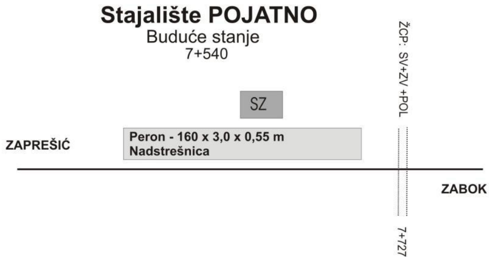
Slika 17. Shematski prikaz stajališta Pojatno nakon rekonstrukcije
