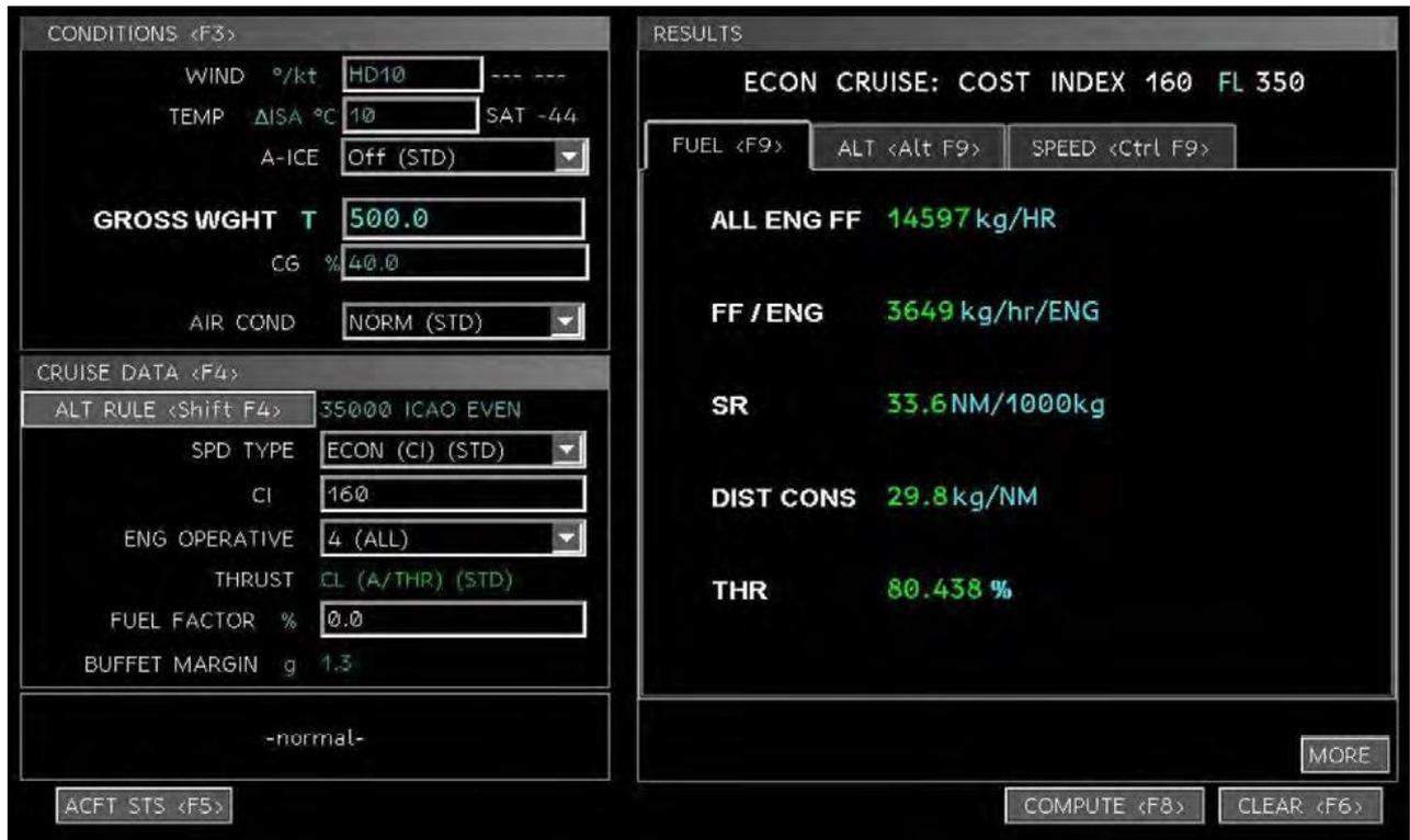
Slika 19: Prikaz sučelja za izračun potrošnje goriva u kabini zrakoplova Airbus A380
