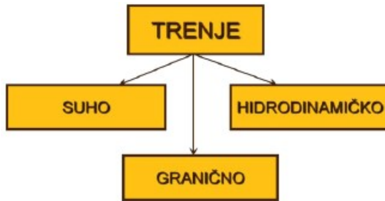
Slika 5. Karakteristični slučajevi trenja [7]
