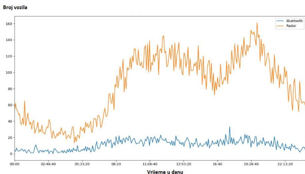
Slika 17 Broj vozila u 5-minutnim intervalima izmjereno korištenjem Bluetooth-a i radara u subotu
