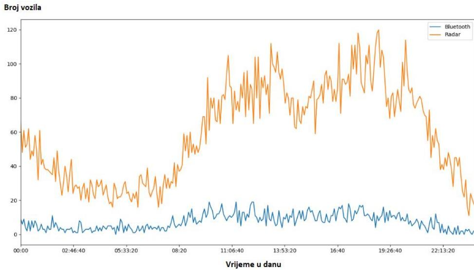
Slika 18 Broj vozila u 5-minutnim intervalima izmjereno korištenjem Bluetooth-a i radara u nedjelju
