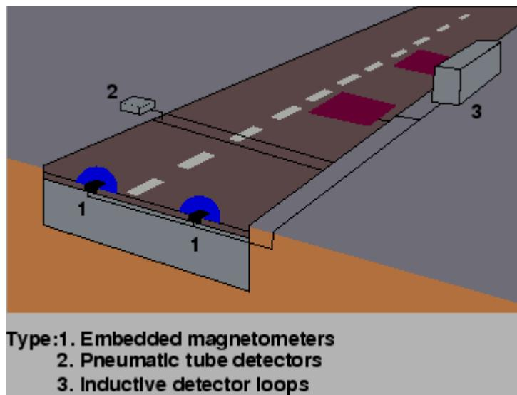
Slika 8 Intruzivni detektori: 1. magnetometar, 2. piezoelektrički detektor, 3. induktivna petlja
