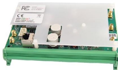
Slika 12 Bluetooth detektor korišten u istraživanju
