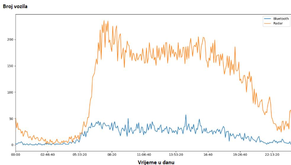
Slika 16 Broj vozila u 5-minutnim intervalima izmjereno korištenjem Bluetooth-a i radara za period od četvrtka do petka
