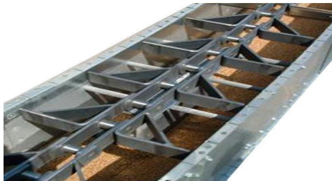
Slika 24. REDLER trakasti transporter
