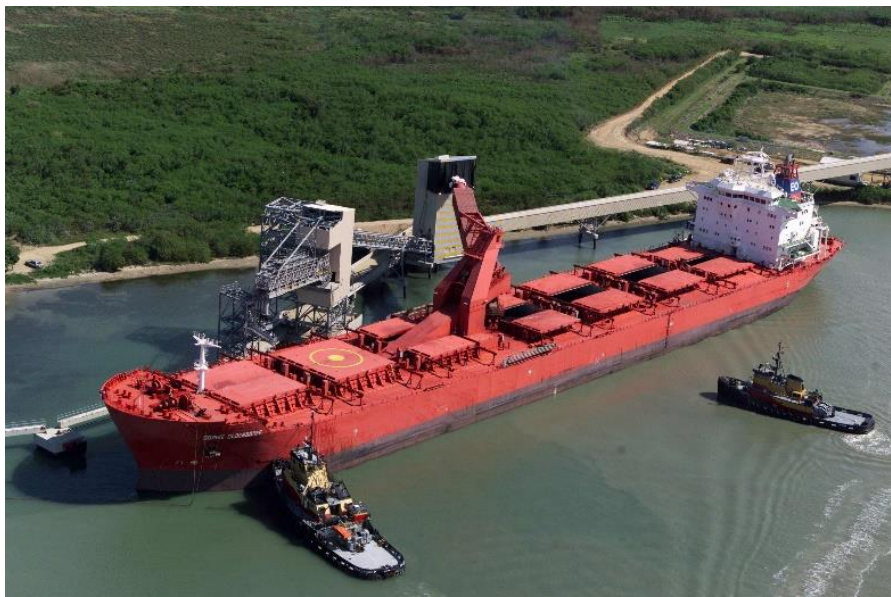
Slika 13. Brod za krute rasute terete s vlastitim uređajem za iskrcaj tereta
