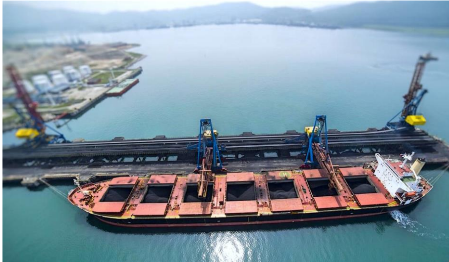
Slika 4. Utovar ugljena u brod
