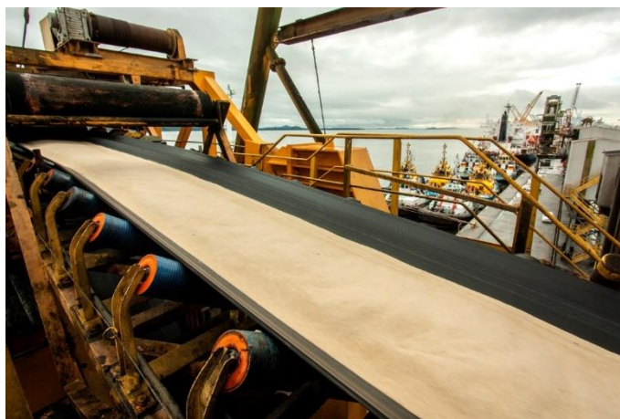
Slika 8. Prekrcaj šećera trakastim transporterom
