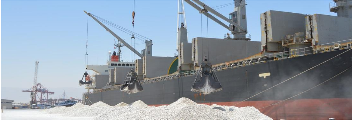
Slika 10. Utovar gipsa pomoću brodskih dizalica u luci Salalah
