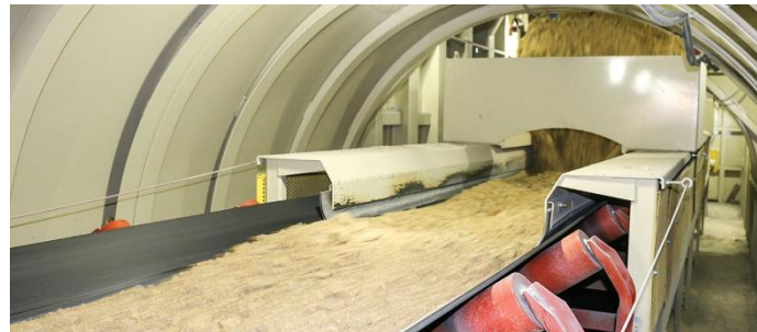
Slika 23. Trakasti transporter ispod skladišta
