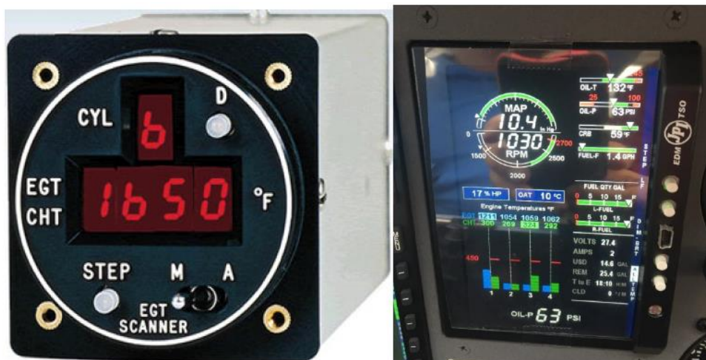
Slika 7: Lijevo: prikaznik uređaja EDM Classic.Scanner Desno: prikaznik uređaja EDM-900 [11]
