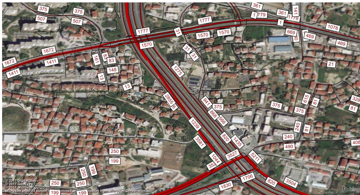
Slika 51. Model prometnih tokova uslijed izgradnje prijelazne rampe
