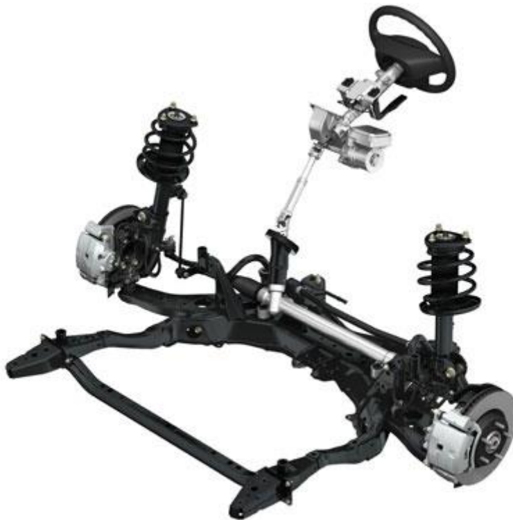
Slika 4. Prikaz upravljačkog mehanizma [11]
