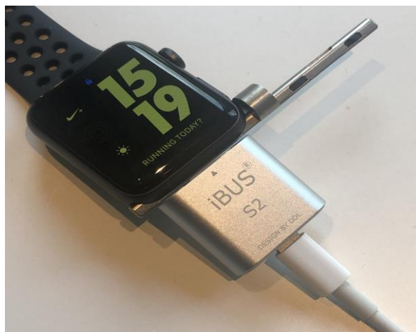
Slika 17: Prikaz povezivanja iWatch -a pomoću iBUS adaptera, [53]
