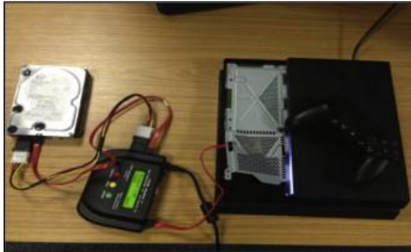
Slika 16: Prikaz povezanog tvrdog diska i Voom Shadow 3 blokatora pisanja, [51]
