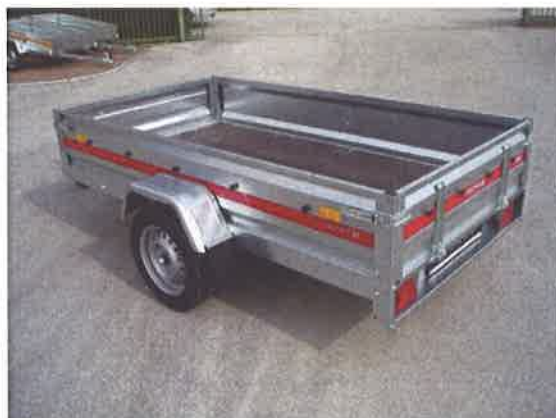
Slika 13. Prikolica za osobna vozila nosivosti 0,75t (sa kočnicom)
