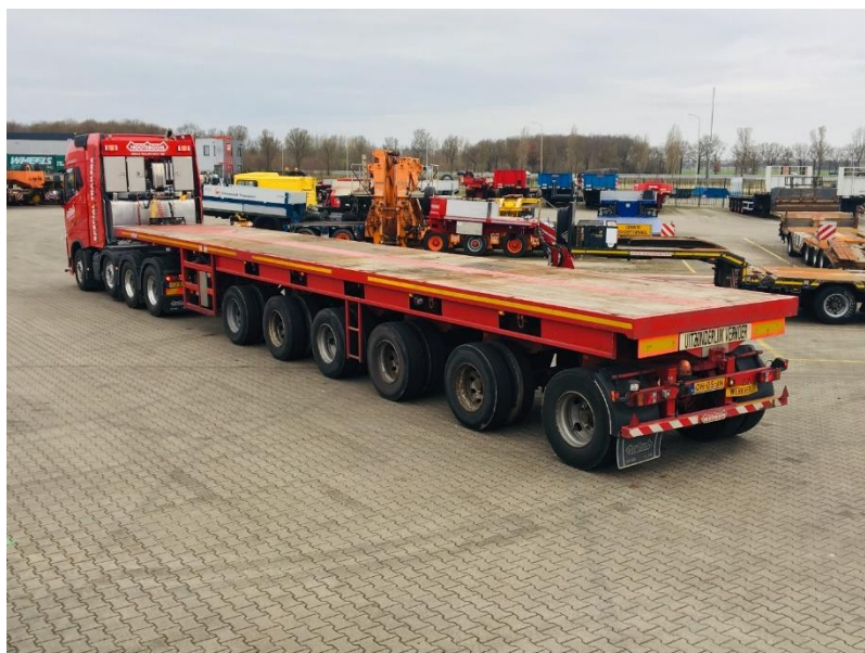
Slika 15: Šesteroosovinska Plato poluprikolica marke Nooteboom OVB-102-06
