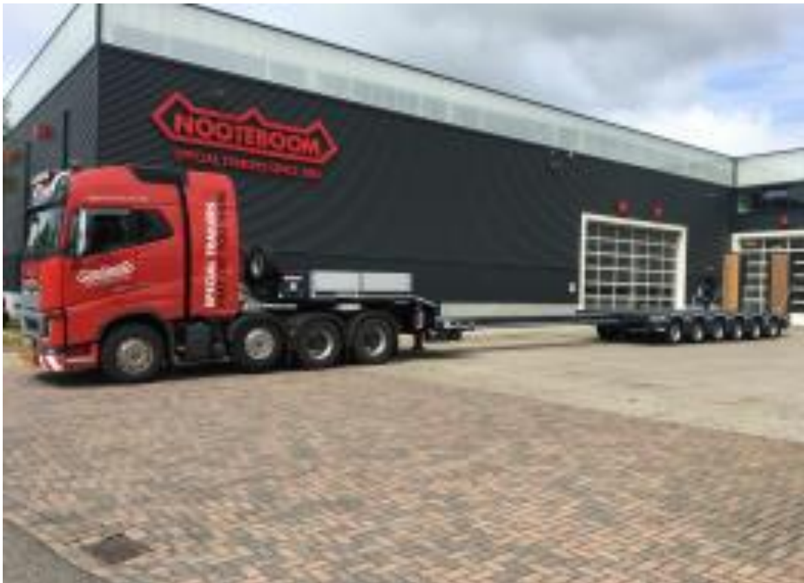
Slika 7: Niskopodna šesteroosovinska poluprikolica marke Nooteboom Stepframetrailer MCO-85-06V
