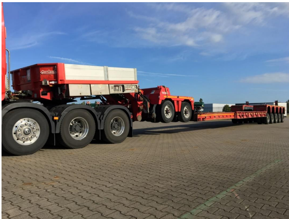
Slika 11: Trodijelna niskopodna sedmeroosovinska poluprikolica marke Nootboom EURO-128-25 (ICP)
