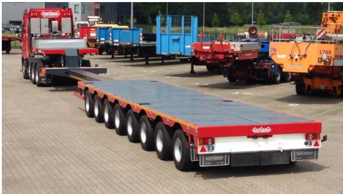
Slika 9: Niskopodna osmerosovinska poluprikolica marke Nootboom MCO-121-08V
