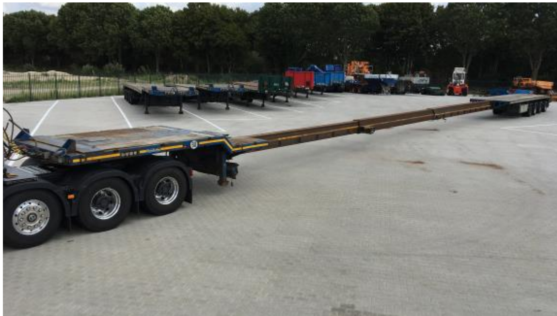
Slika 13: Četveroosovinska plato poluprikolica marke Goldhofer STZ-DL4-46/80 AA
