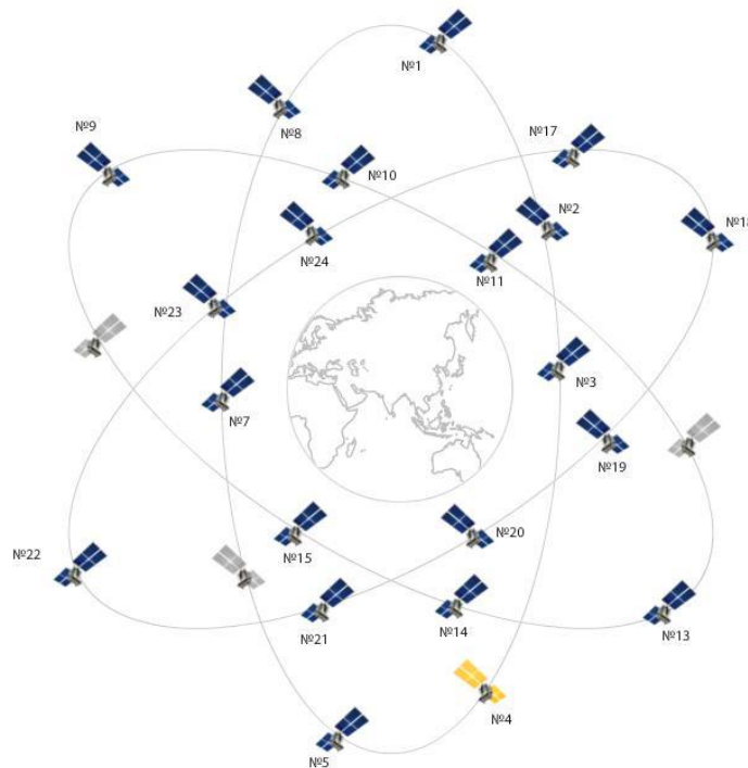
Slika 5. Orbite GLONASS satelita
