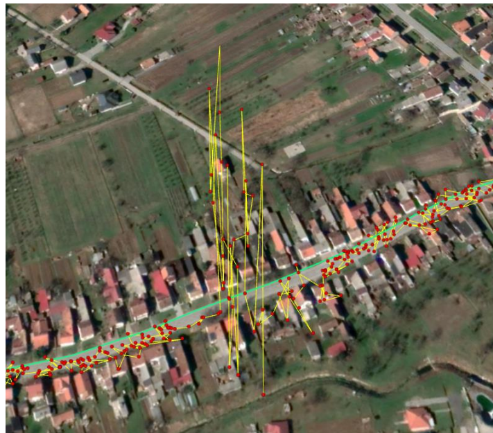
Slika 56. Najveće odstupanje GLONASS sustava
