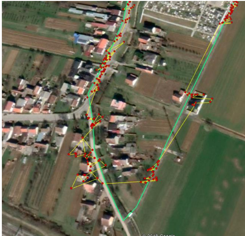
Slika 63. Najveće odstupanje Galileo sustava
