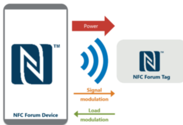
Slika 4. Princip rada NFC uređaja i oznake, [43]
