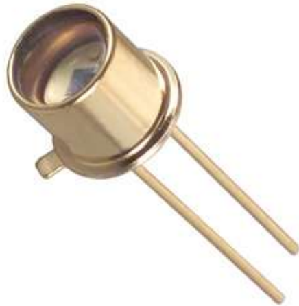
Slika 11. Prikaz izgleda fotodetektor PIN dioda [19].
