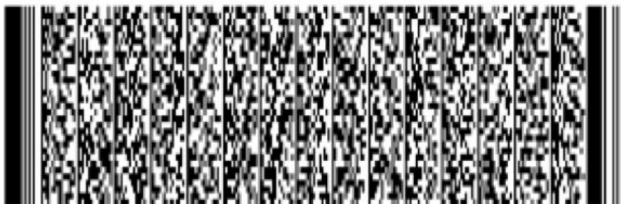
Slika 9. Dvodimenzionalni PDF 417 bar kod Izvor: [2]
