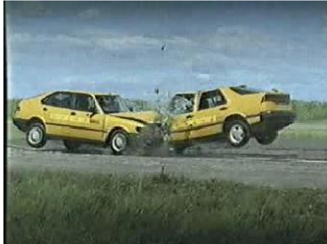
Slika 3. Djelomični frontalni sudar
