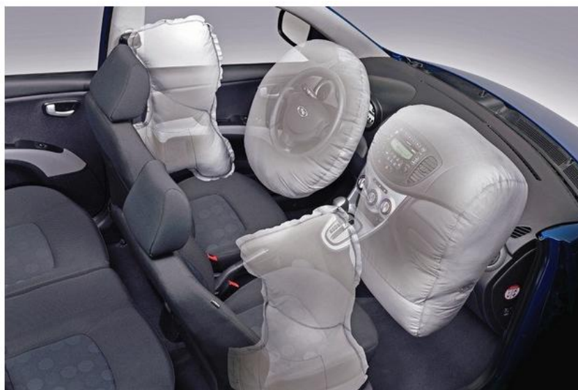
Slika 30. Prikaz područja obuhvata zračnim jastucima u suvremenim vozilima
