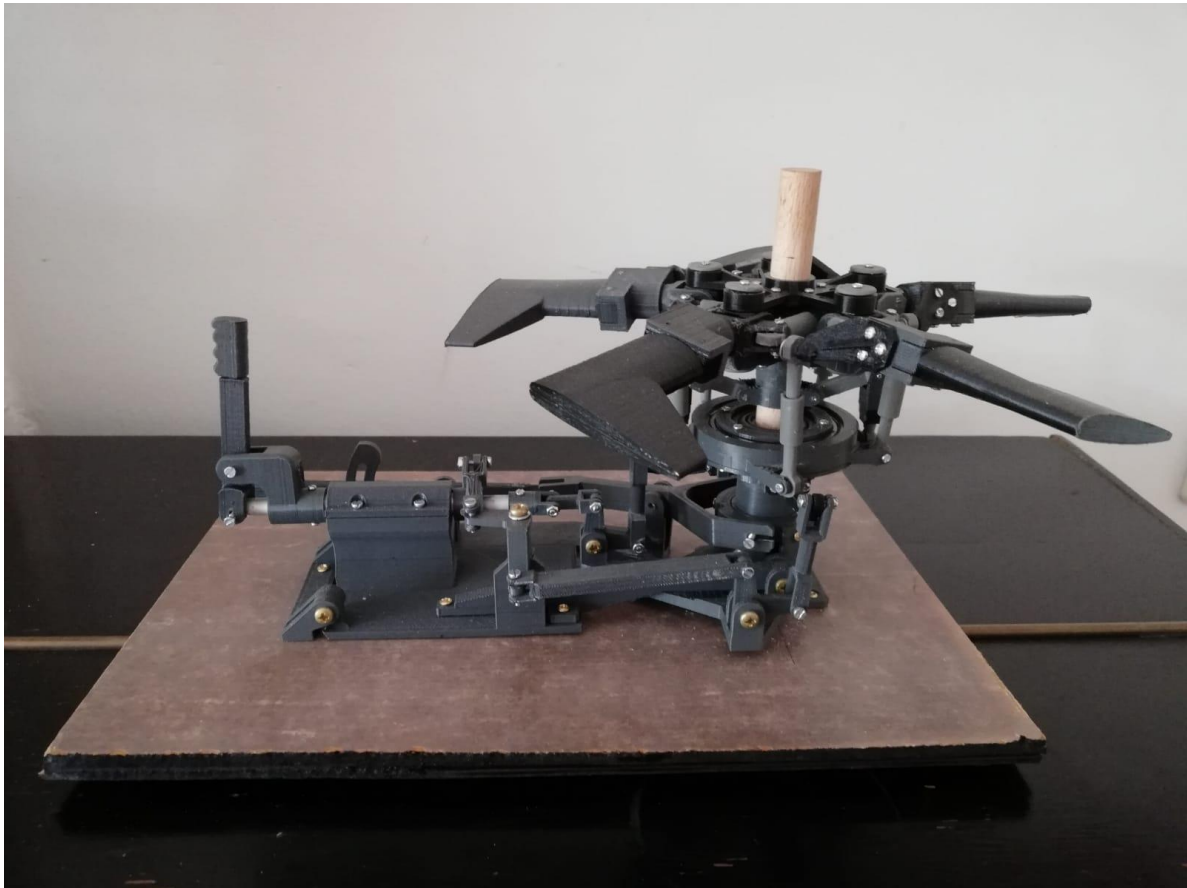
Slika 6.33 Model nosivog rotora – ciklična komanda
