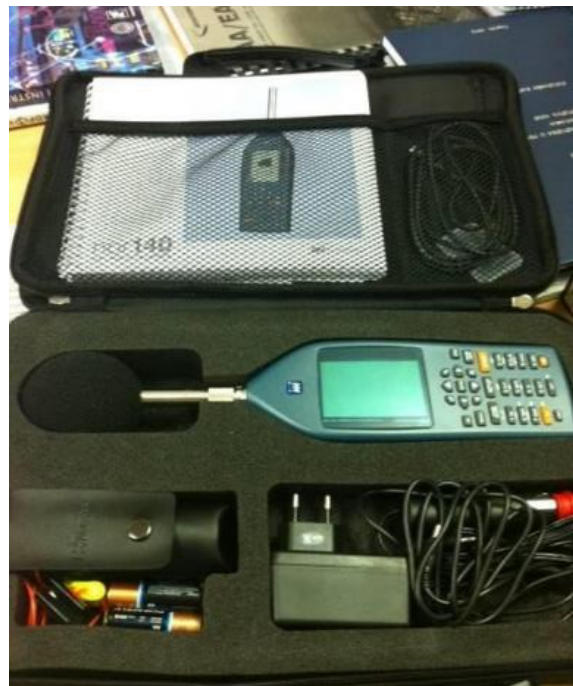
Slika 13: Zvukomjer Norsonic Nor140, Izvor: http://static.fpz.hr/FPZWeb/files/pravilnici/Katalog-laboratorijske-opreme-2013-2016.pdf
