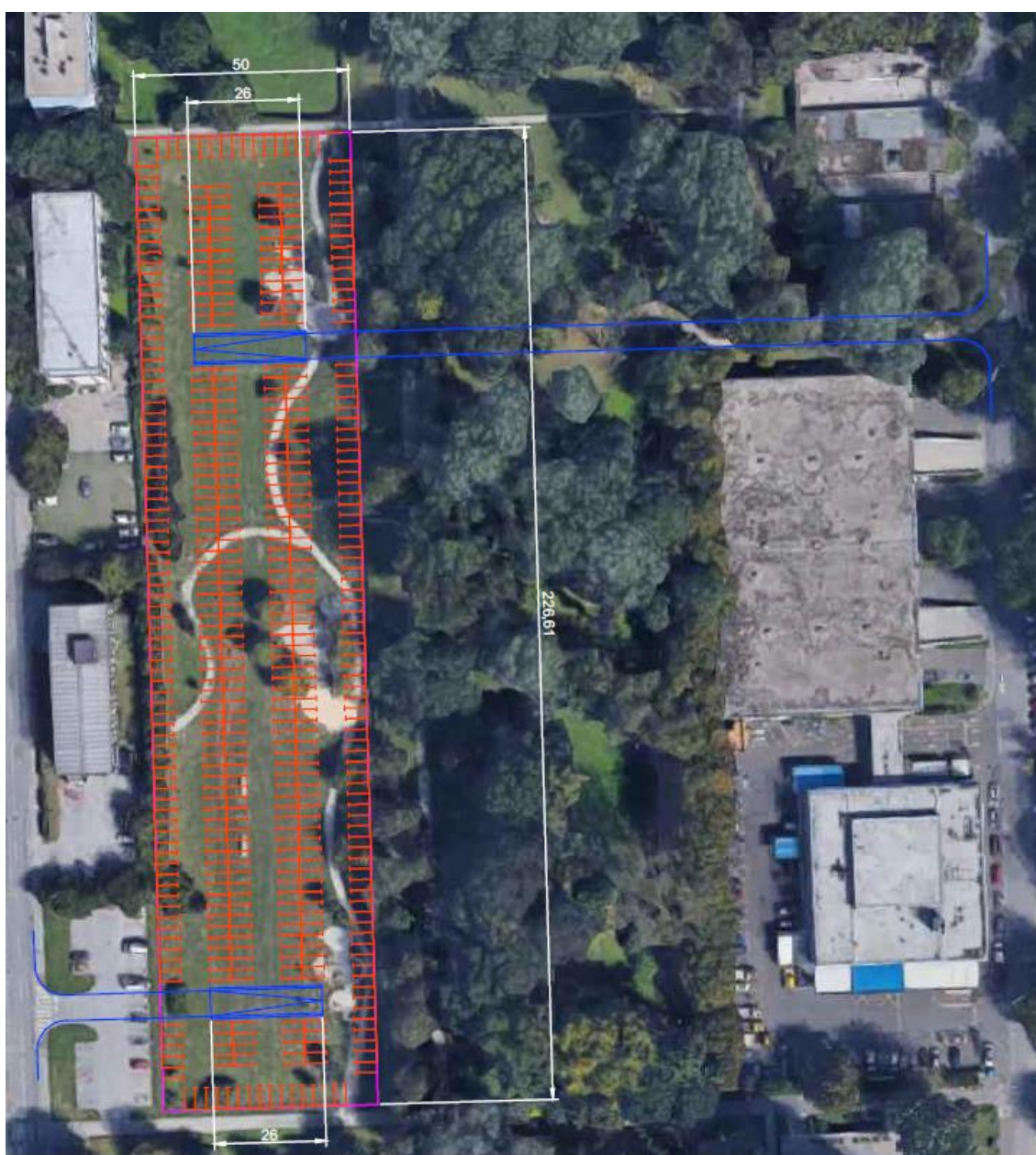
Slika 28. Idejno projektno rješenje podzemne garaže u ulici Trnsko
