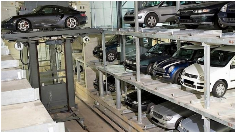
Slika 24. Pomična platforma po horizontalnoj i vertikalnoj osi; [12]
