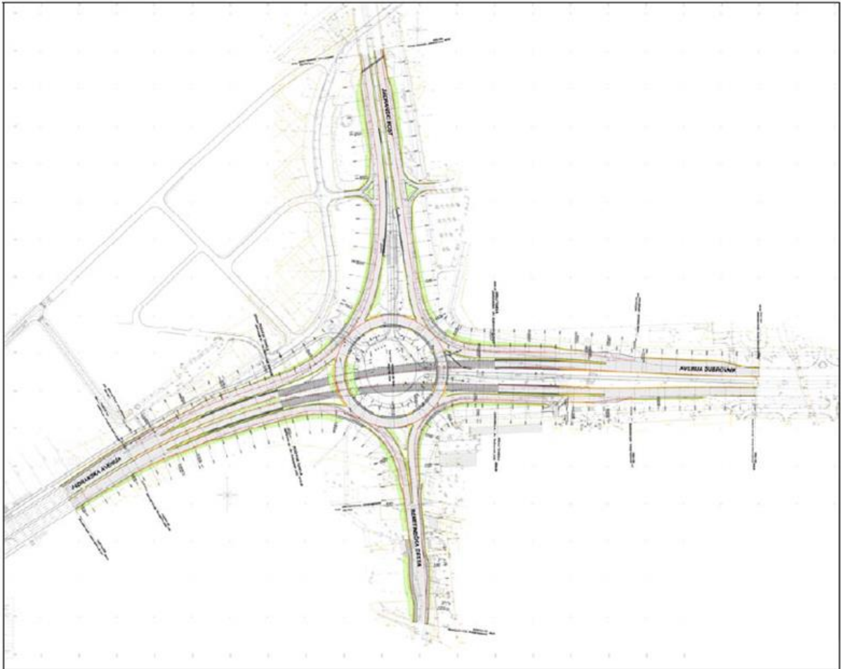
Slika 5.2. Kružno raskrižje „Remetinec“ _Postojeće stanje s denivelacijom, [11]
