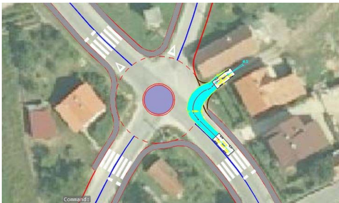
Slika 31. Prikaz zadovoljene provoznosti privoza 3 u dvorište u programskom alatu AutoTURN
