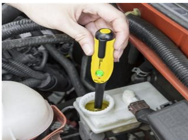
Slika 25. Uređaj za ispitivanje kočione tekućine
