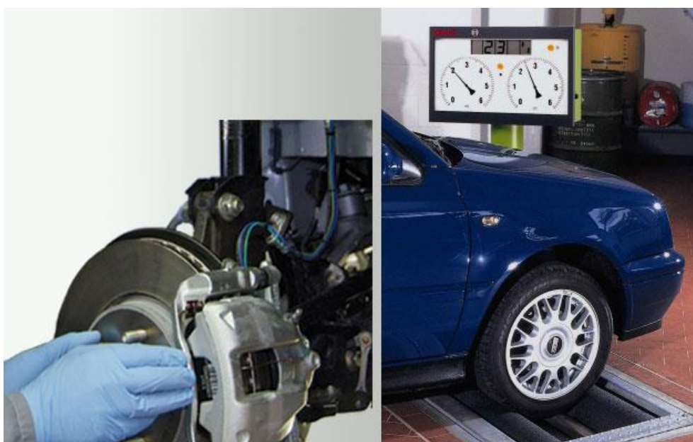
Slika 24. Valjci s mjernim instrumentom
