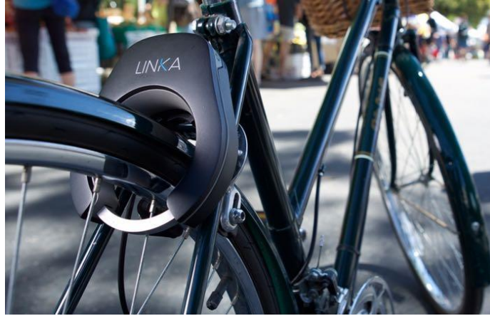
Slika 5.4. Zaključavanje bicikla pomoću "smart-lock" sistema [35]
