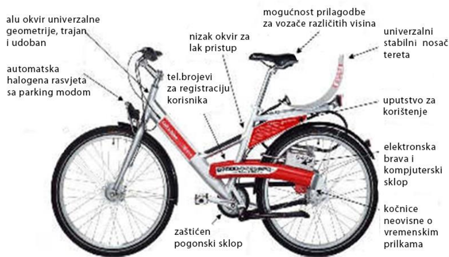
Slika 4.6. Konstrukcija javnog bicikla [34]
