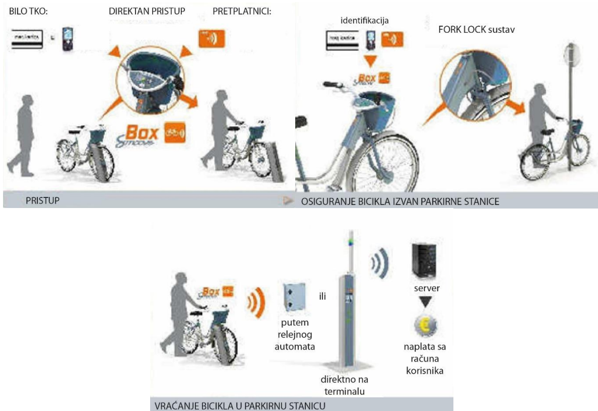
Slika 4.4. Funkcioniranje standardnog sustava javnih bicikala [34]
