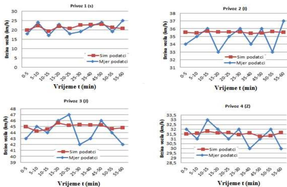
*Grafikon 4.1. Prikaz simuliranih i mjerjenih brzina na RKT-u*
