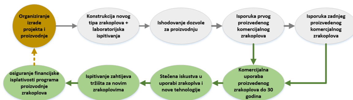
Slika 1. Dijagram toka aktivnosti konstrukcije, proizvodnje i korištenja novog tipa zrakoplova, [2]
