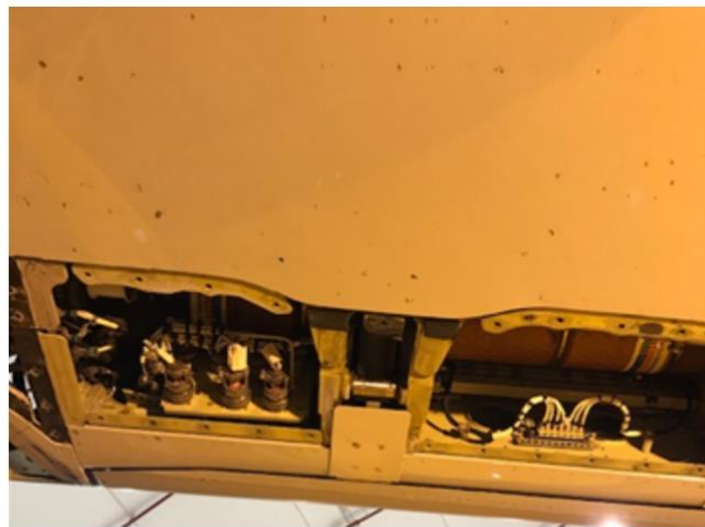
ZONA-500 krilo zrakoplova izloženost vibracijama, i okolini leta
