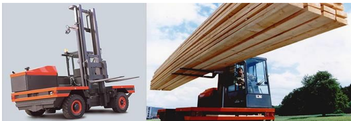
Slika 11. Prikaz bočnog viličara Izvor: [20]
