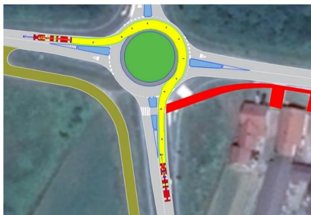
Slika 17. Provjera provoznosti za privoz 1 - lijevo
