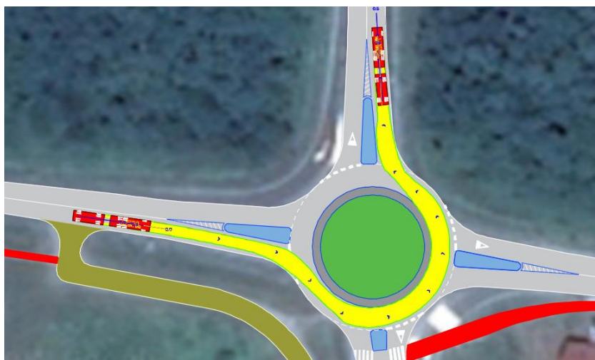
Slika 26. Provjera proznosti za prvoz 4 - lijevo
