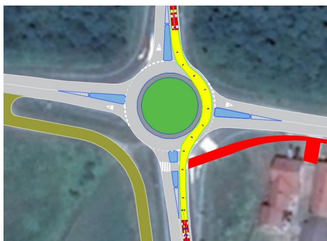
Slika 16. Provjera provoznosti za privoz 1 - ravno
