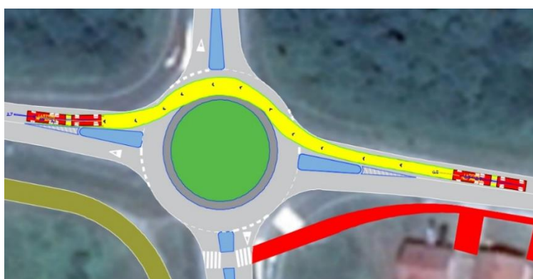
Slika 19. Provjera provoznosti za privoz 2 - ravno
