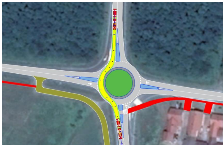
Slika 22. Provjera provoznosti za privoz 3 - ravno
