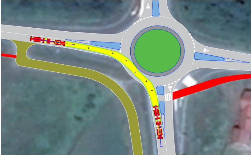
Slika 24. Provjera provoznosti za privoz 4 - desno
