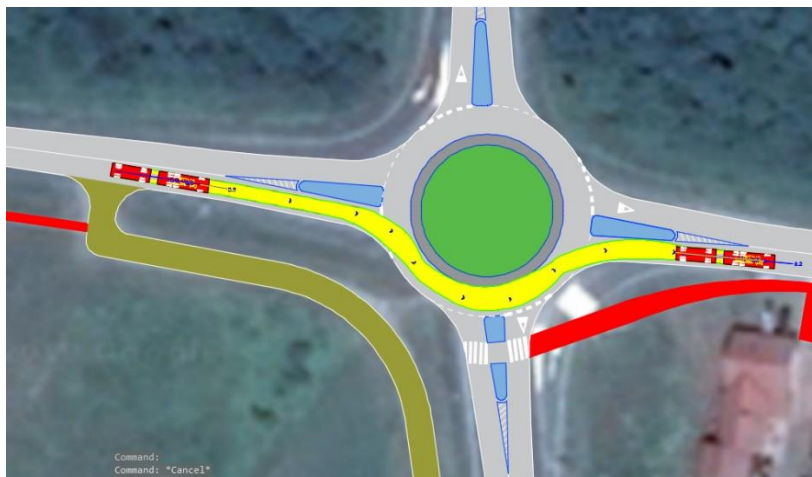
Slika 25. Provjera proznosti za prvoz 4 - ravno
