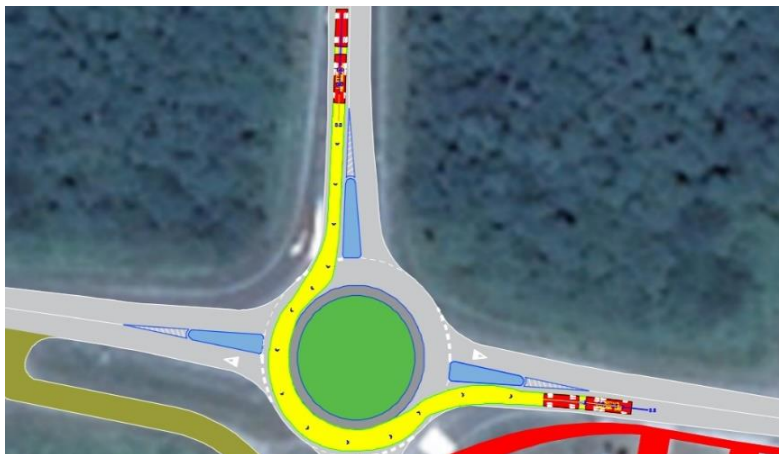
Slika 23. Provjera provoznosti za privoz 3 - lijevo
