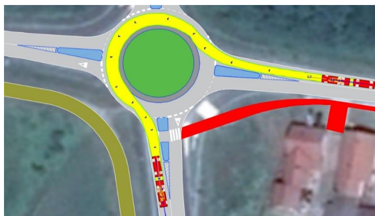
Slika 20. Provjera provoznosti za privoz 2 - lijevo
