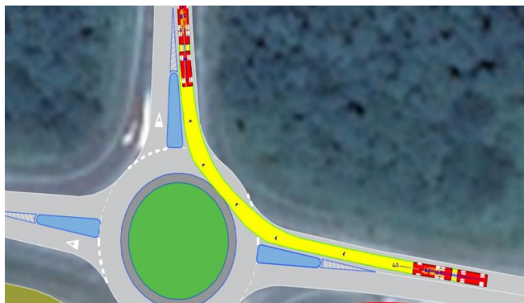
Slika 18. Provjera provoznosti za privoz 2 - desno
