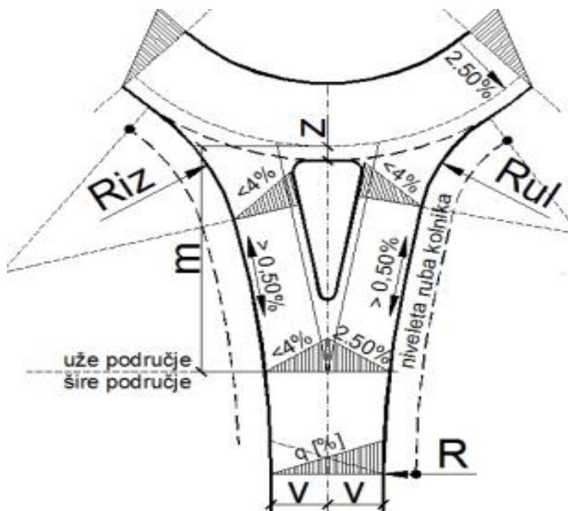
Slika 13. Poprečni nagib ulaza, izlaza i kružnog kolnika
