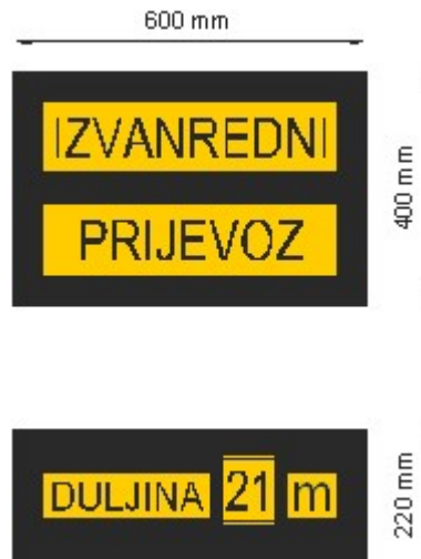
Slika 4. Skica oznake “izvanredni prijevoz” i dodatne oznake “Duljina.....m”
