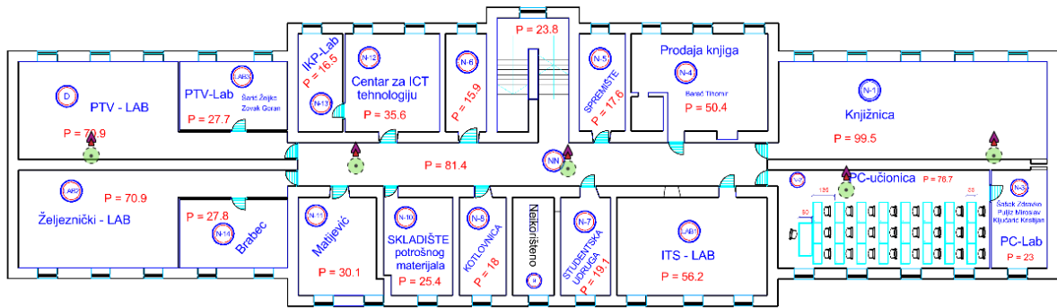
Slika 107 Raspored pristupnih točaka u podrumu.
