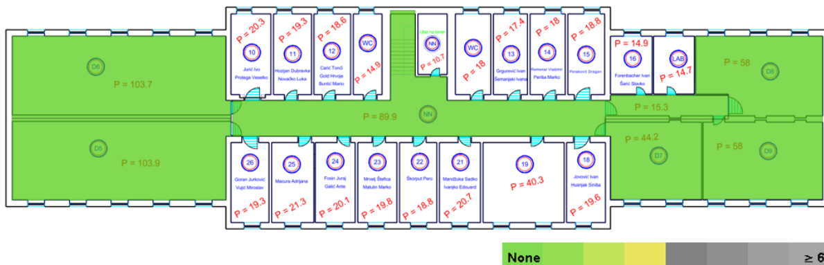
Slika 101 Preklapanje kanala u 5 GHz pojasu na katu.
