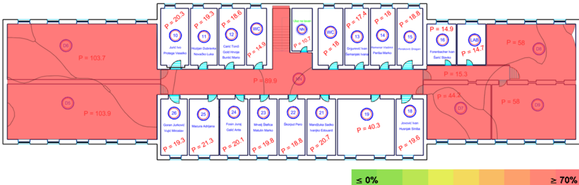
Slika 56 Iskorištenost zračnog sučelja na katu u 5 GHz pojasu.
