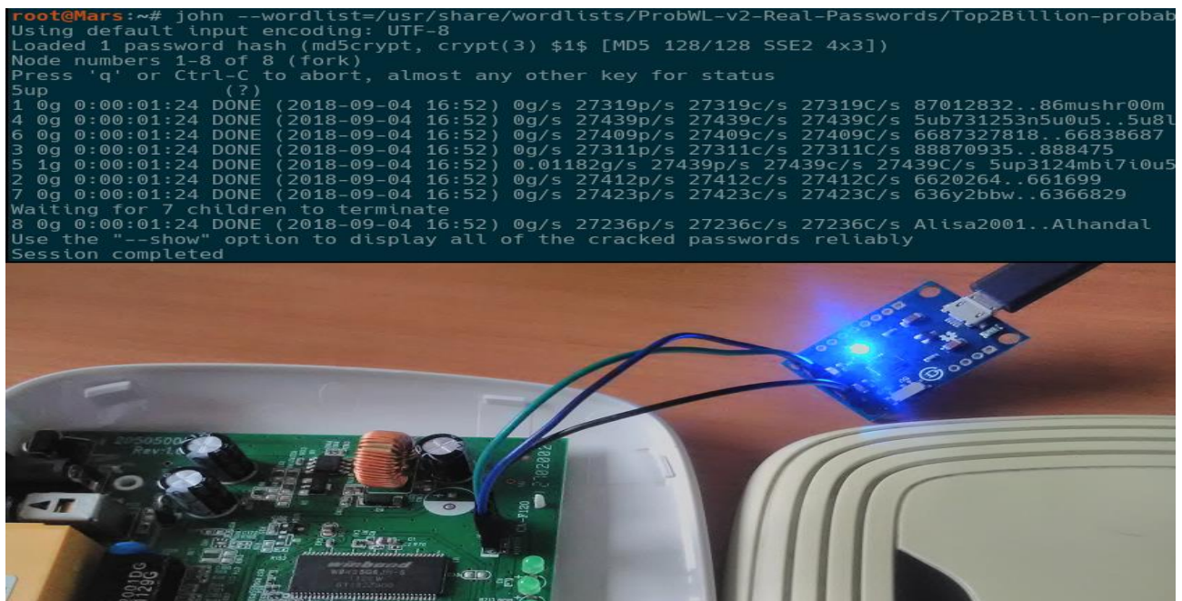
Slika 19. Gore: prikaz rezultata dekriptiranja administratorske lozinke u programskom alatu John . Dolje: prikaz načina pristupa na UART sučelje usmjernika
