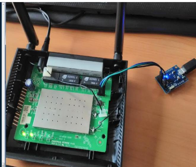
**Slika 12.** Lijevo: Linux konzola s ispisanim osnovnim informacijama o sustavu. Desno: način spajanja na usmijernik kako bi se pristupilo Linux konzoli
