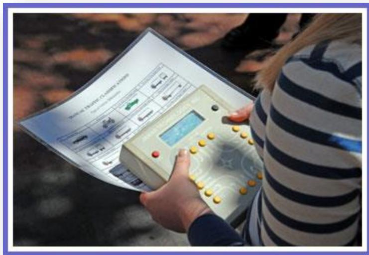
Slika 2.Primjer brojanja prometa sa električnim brojačem
