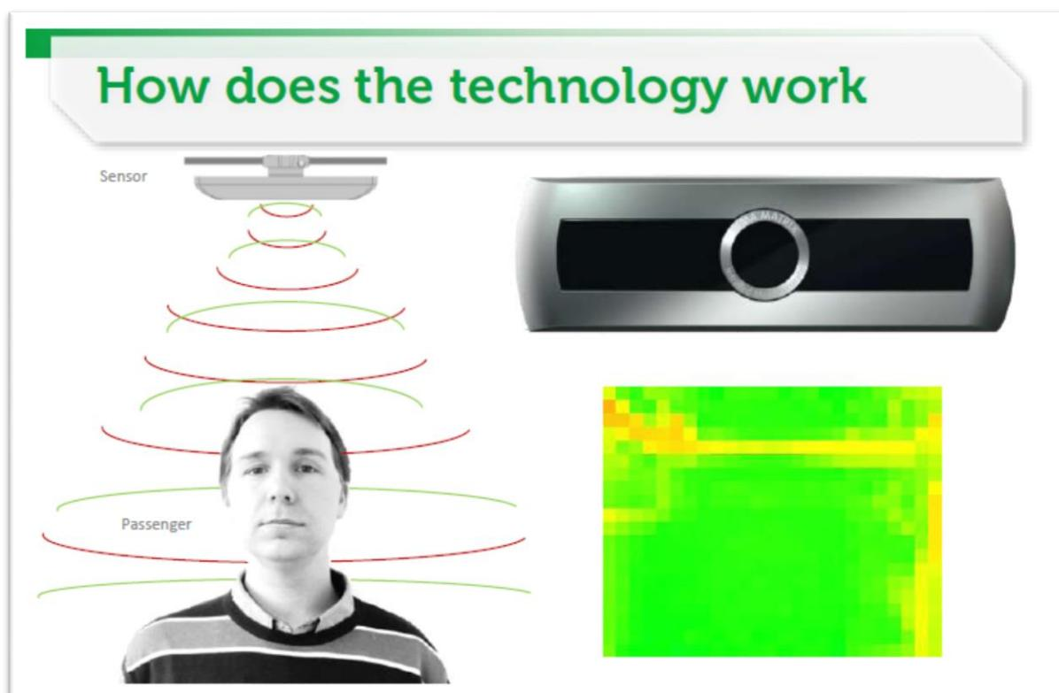
Slika 9. Princip brojanja putnika tehnologije APC-a Irma Matrix senzora
