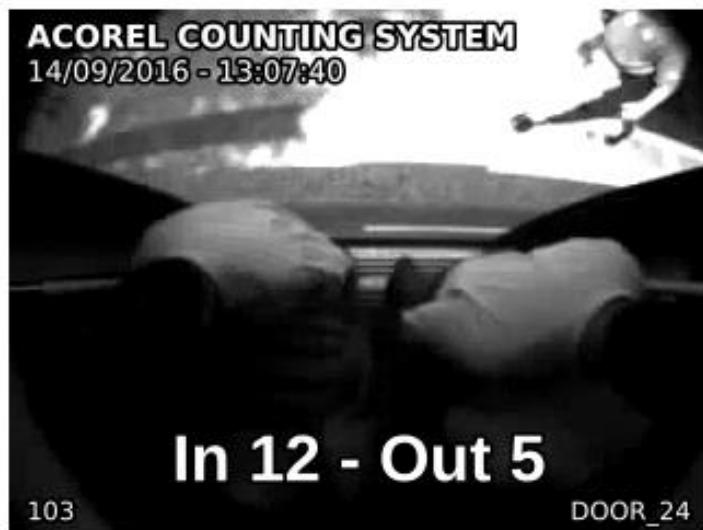
Slika 6. Prikaz brojanja stereoskopskim 3D senzorom
