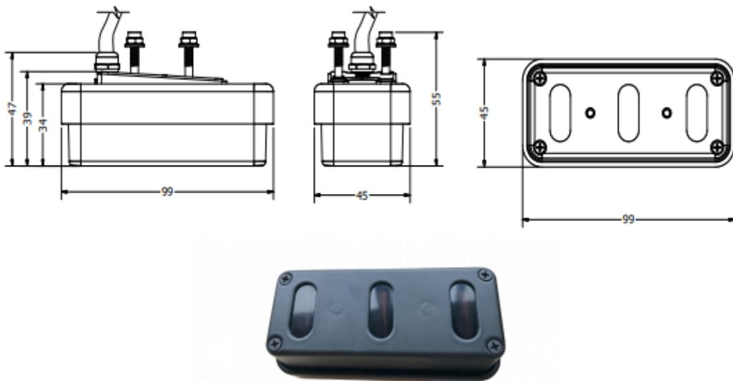
Slika 12. Dimenzije (mm) i izgled senzora DA-200
