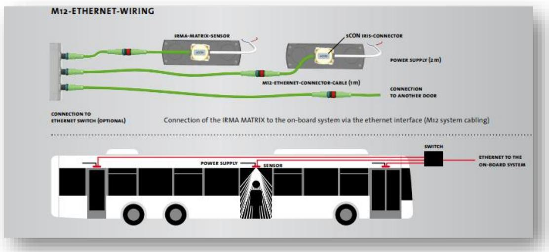
Slika 11. Povezivanje IRMA matrix uređaja s pločom putem ethernet sučelja
