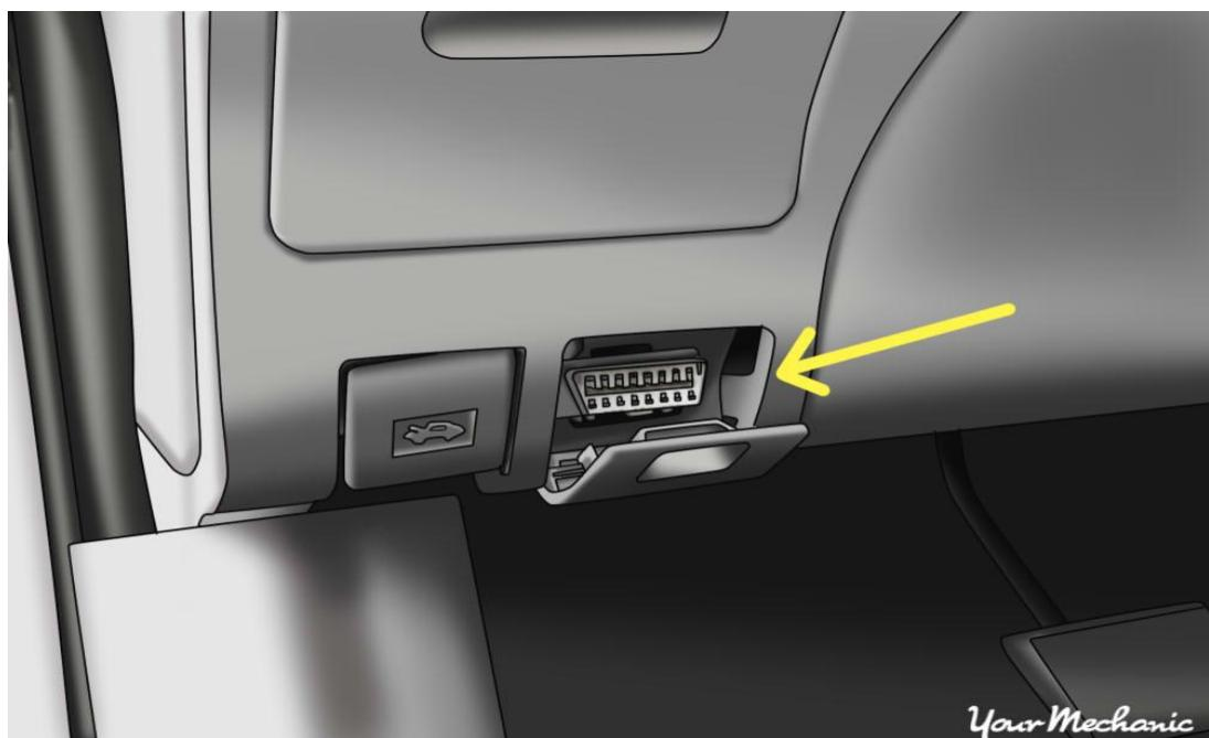
Slika 9. OBD priključak na vozilu
