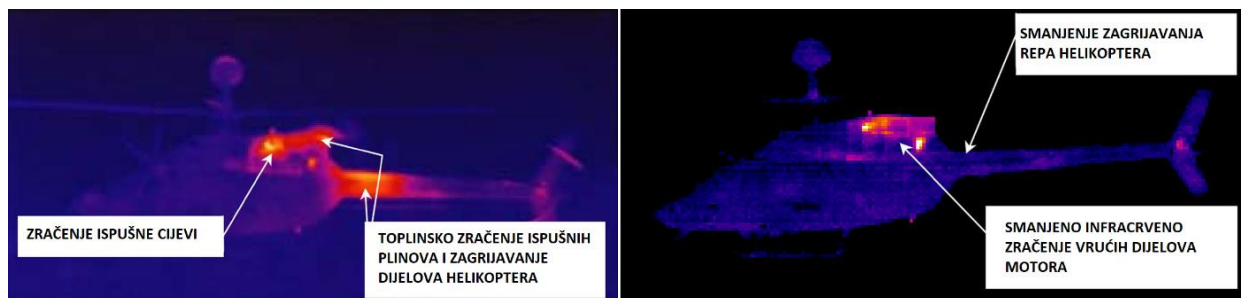
Slika 20. Usporedba toplinskih odraza helikoptera OH-58D prije i nakon preinake ispušne cijevi Izvor: [9]
