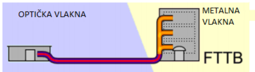
Slika 14 FTTB arhitektura do korisnika, izradio autor prema[24]
