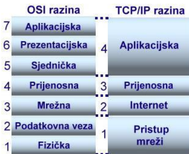
Slika 5. Odnos OSI modela i TCP/IP arhitekture, [8]
