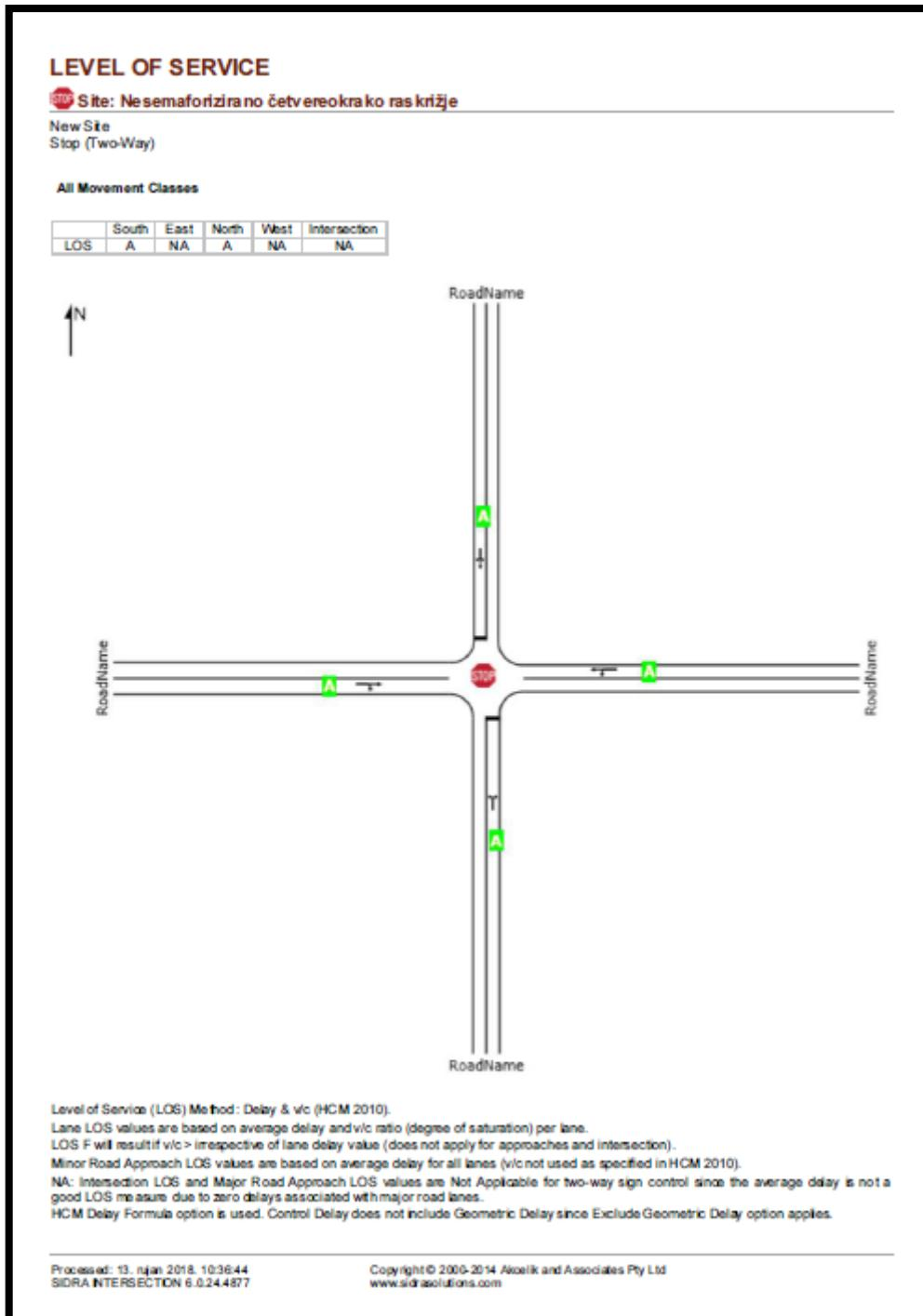
Slika 45. Prikaz razine usluge psotojeceg stanja pomoću programskog alata SIDRA INTERSECTION
