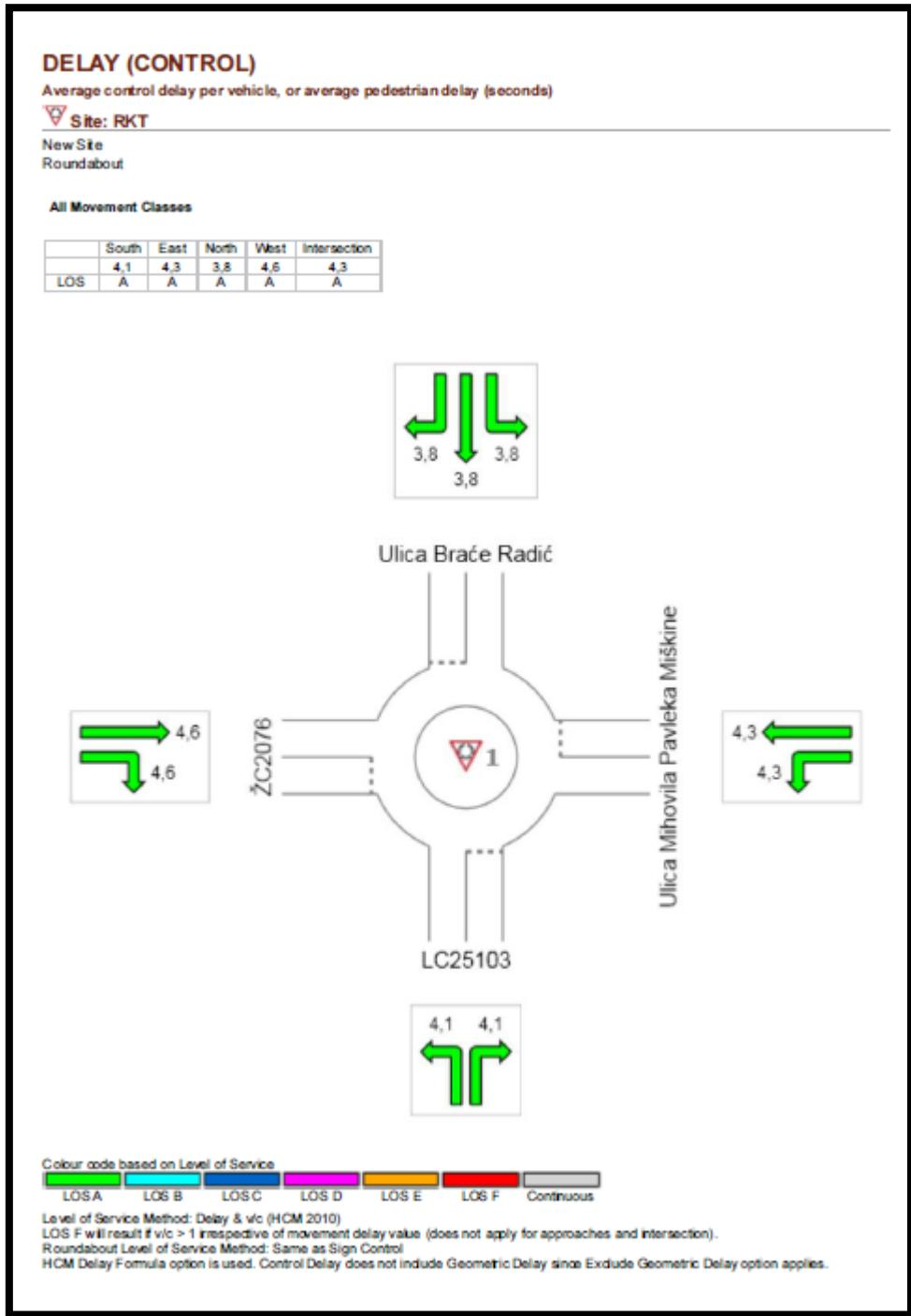
Slika 49. Prikaz rezultata prosječnog vremena kašnjenja dobivenih pomoći programskog alata SIDRA INTERSECTION
