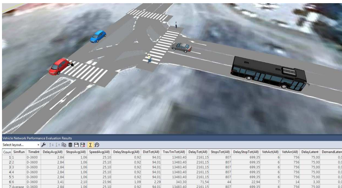
Slika 57. Simulacija prijedloga rješenja za raskrižje Kolodvorske ulice i Ulice Ivana Meštrovića
